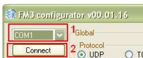
Fig. 5.3.1.1 COM port drop-box
